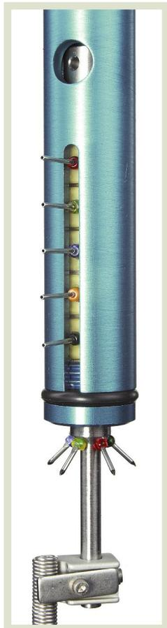
为了解决这些问题，Instech保持密封紧密，但添加了电机协助旋转。控制器感知动物的运动，并驱动旋转核心跟随动物。与基于开关的系统不同，这种转体具有比例控制功能，允许精细的连续运动，以将动物承受的压力降低。动物感受到的扭矩类似于Instech单通道旋转。
